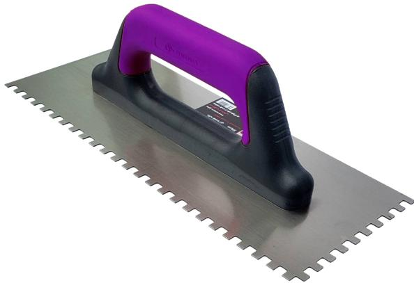
یکی از تجهیزات کارآمد و مفید در نصب کاشی و سرامیک، ماله شانه‌ای است. این محصول جهت پهن کردن چسب کاشی به صورت یکدست و به ضخامت معین و منظم کاربرد دارد. در هنگام چسب زدن زیر کار و یا پشت کاشی حتماً باید از ماله و یا کاردک شانه‌ای برای داشتن فضای و جای نفس کشیدن چسب استفاده کرد.
